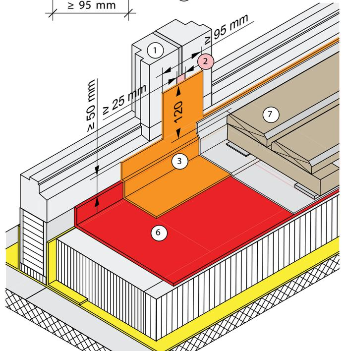
Abb. 49: Elementstoss mit Bewegungsfuge; Rahmen (1), Entkoppelungsband (2), FLK (3), kraftschlüssige Verbindung (4), Metallprofil (5), Abdichtung (6), OK Nutzschiicht (7)
